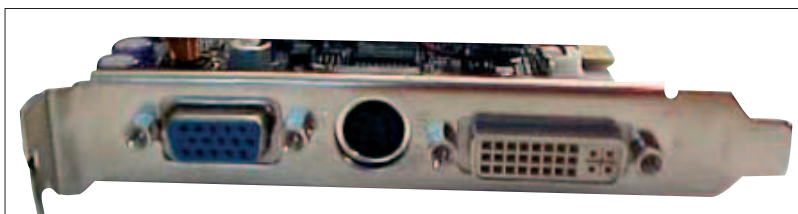
Разъемы слева направо: D-Sub, 7pin (S-video-подобный), DVI
