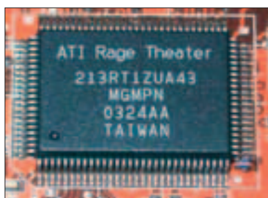
Именно этот чип позволяет выводить картинку на экран телевизора
