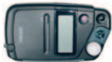
Этот прибор используют операторы для измерения освещенности объекта съемки
